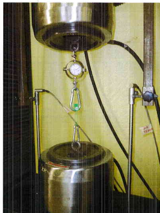
b) sistema di misura del carico.
